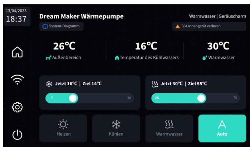
Im Automatikbetrieb, wenn die Heißwasserfunktion konfiguriert ist und das Heißwasser die Zieltemperatur nicht erreicht, wird die Wärmepumpe zuerst den Heißwasserbetrieb ausführen und danach auf der Grundlage der Systemlogik den Kühl-/Heizbetrieb bestimmen.
